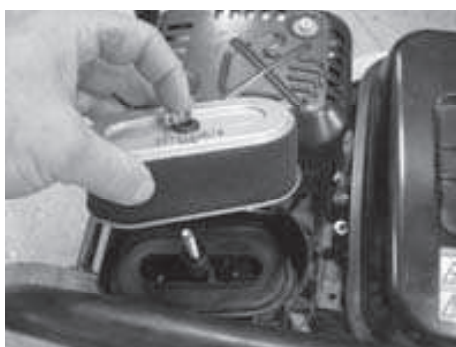
Рис. Замена воздушного фильтра.
